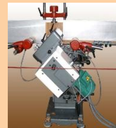
spezielle Langlochbohrmaschine, um Gehrungen fräsen zu können
