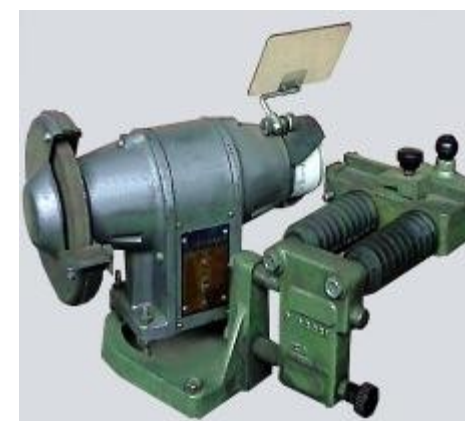
Maschine für das Schärfen der Alternax-Werkzeuge
