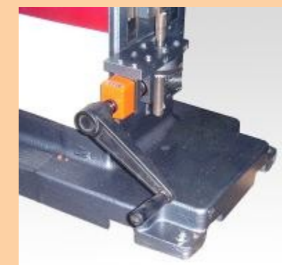
Erhöhen und Absenken der Anlage durch eine mechanische, digital gesteuerte Antriebskurbel und einen Achszähler
