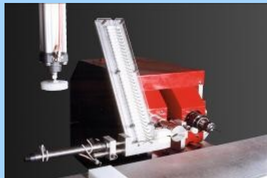
Sicht auf die gesamte Scharniervorrichtung mit Lager für die Anuba-Einbohrbänder (für die Fensterflügel), Bohrvorrichtung und Scharniervorrichtung mit digitaler Rotation.
