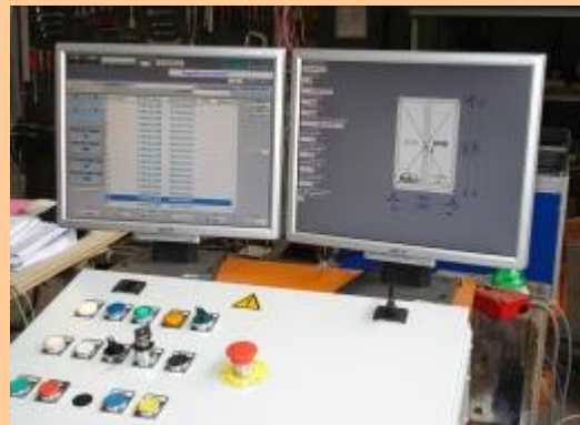
Pupitre de mando equipado de un microordenador conectado a la GPAO del cliente. La pantalla de la izquierda lista los programas piezas en curso y por venir. La pantalla de la derecha muestra las dimensiones de la carpintería en curso de enmarcado.
