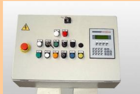
Pupitre de mando equipado de un terminal de programación
