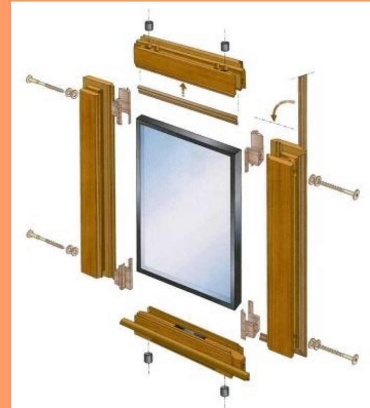
Ejemplo de carpintería de ensamblaje mecánico que utiliza la técnica de tornillo con inserto que hace la carpintería desmontable. Una pieza defectuosa o el acristalamiento puede cambiarse por ejemplo.
