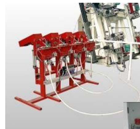
Recipientes oscilantes de distribución de los tornillos
