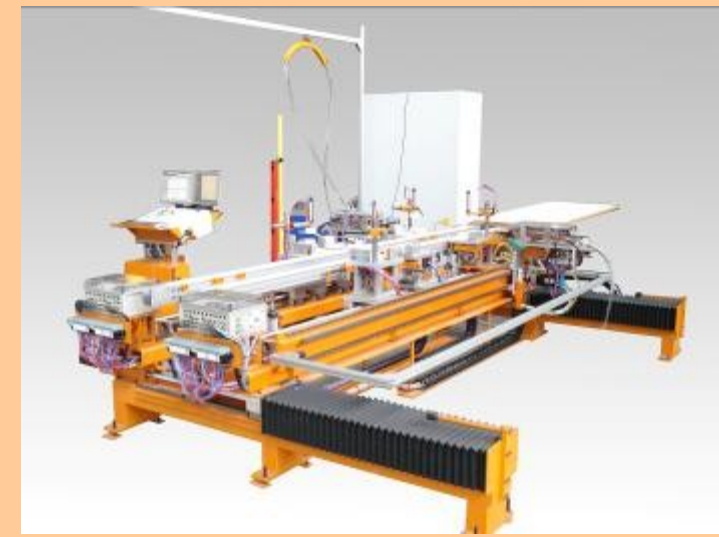
Enmarcadora atornilladora horizontal con evacuación automática en línea de las carpinterías.
