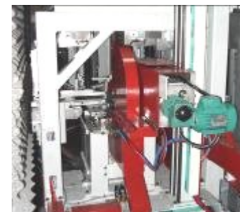
Puesto de troceo para cortes variable de -45^\circ a +45^\circ
