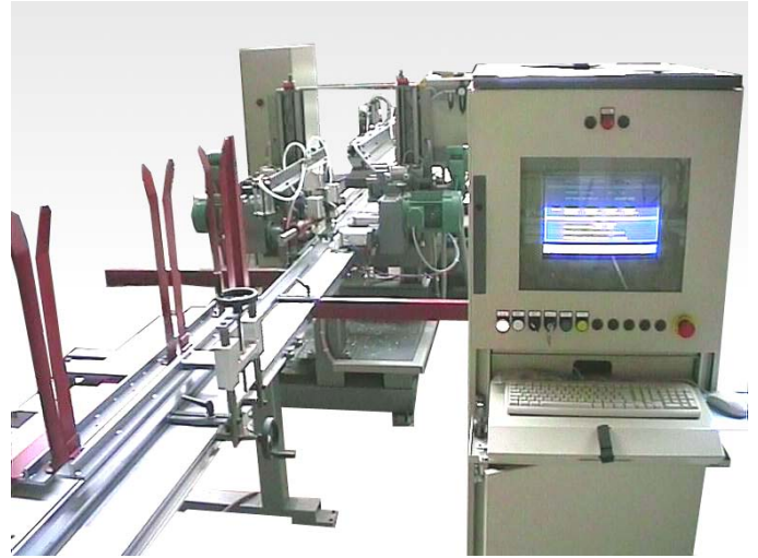
Vue d'ensemble d'une machine avec magasin chargeur vertical en entrée. Au premier plan le pupitre de commande.
