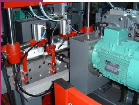
Vue d'un groupe de perçage. Vitesse de rotation : 750 i/mn. Puissance : 1 KW. Avance travail électrique. Forêt Ø 5 mm. Réglages en vertical et horizontal transversal manuels par vis écrou. Lubrification par nébulisation (air comprimé + huile)
