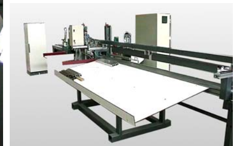
Sortie machine. Les pièces après usinage sont évacuées vers un magasin horizontal de stockage.
