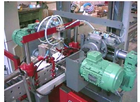
Vue des 2 têtes de perçage en vis à vis. Le bridage des mèches se fait par pinces pour une meilleur concentricité. On remarquera la lubrification des mèches par pulvérisation d'huile. Les pièces sont bridées par vérins pneumatiques.
