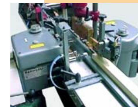
Mortaiseuse spéciale à 2 unités en vis-à-vis
