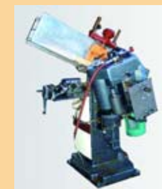
Mortaiseuse spéciale pour réaliser des coupes d'onglets
