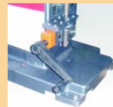
Système de monte et baisse de l'unité par manivelle et compteur mécanique numérique
