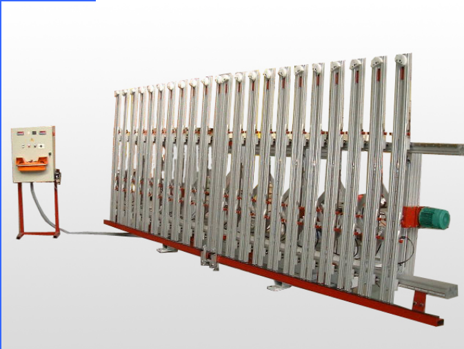
Vue d'ensemble de la cadreuse en position verticale avec son pupitre de commande.
