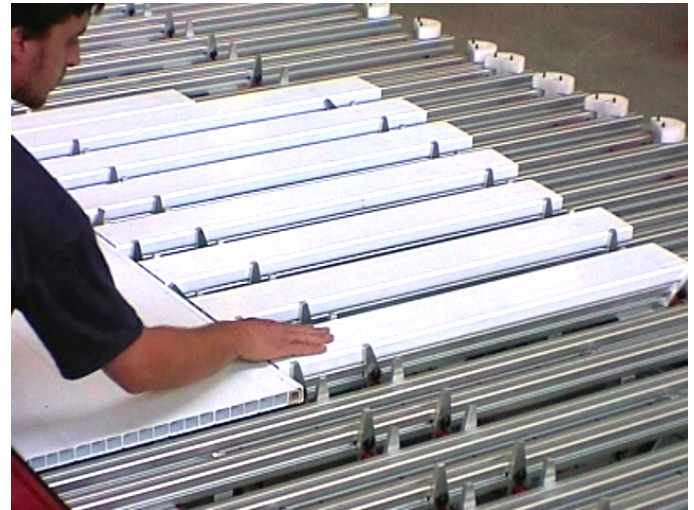
Montage d'un portail. La cadreuse permet de répartir automatiquement l'entr'axe entre chaque lame du portail. Des taquets escamotables permettent le maintien de chaque lame.
