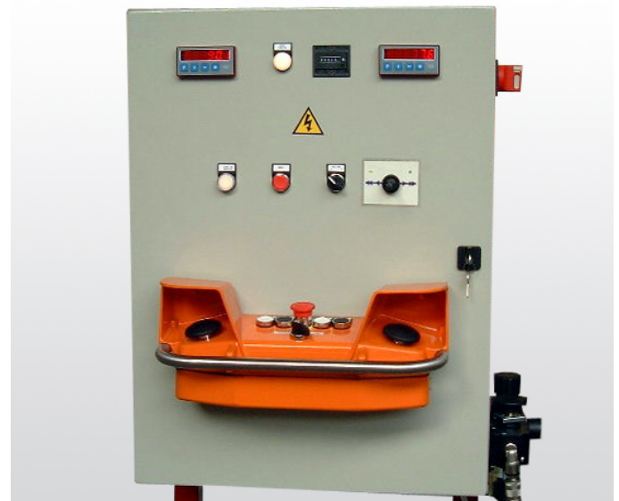
Vue de détails du pupitre de commande. Réglage électrique du pas entre les lames. Commande bi-manuelle de basculement de la cadreuse.
