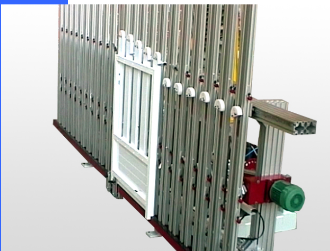
Portail monté prêt à être évacué latéralement. Les presseurs sont sortis et maintiennent la menuiserie.
