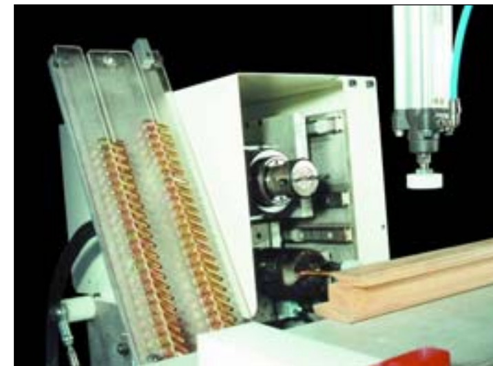
Vue de l'ensemble de la tête de fichage avec le magasin de fiches Anuba ouvrants + dormants (option), le groupe de perçage et le groupe de fichage à rotation numérique
