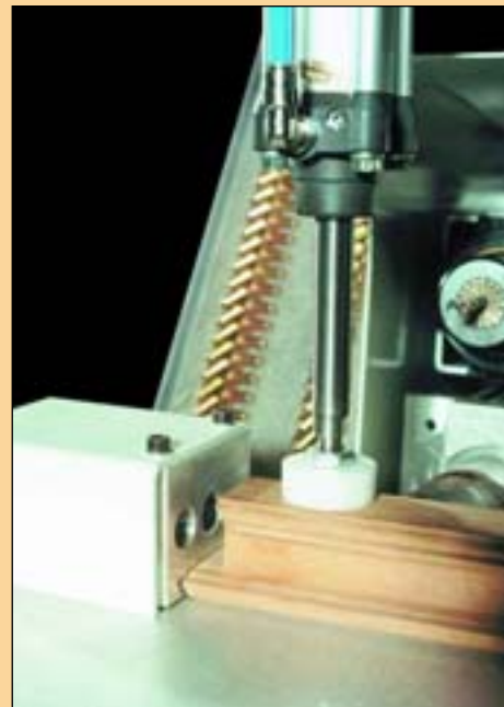
Vue de la butée de référence avec sa cellule de détection pièce
