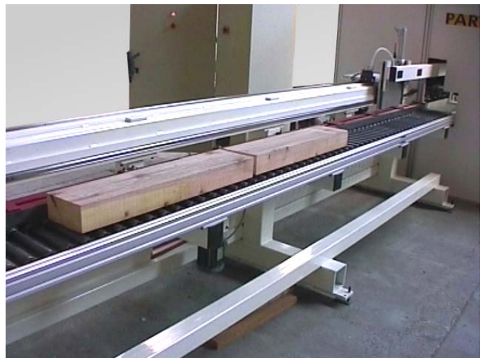
Evacuation des pièces tronçonnées.
