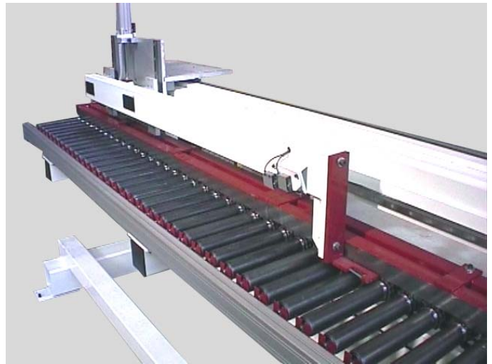
Vue de la table à rouleaux motorisés d'évacuation des bois avec la butée numérisée.
