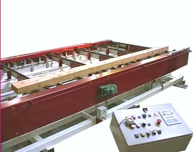
Vue du magasin chargeur. Celui-ci sert de stock tampon entre une corroyeuse en amont et la tronçonneuse en aval.
