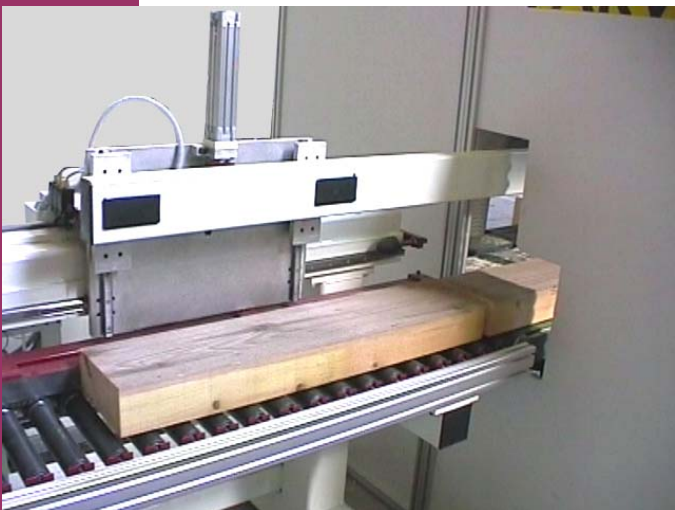
Pièces tronçonnées en cours d'évacuation. La butée est alors relevée.
