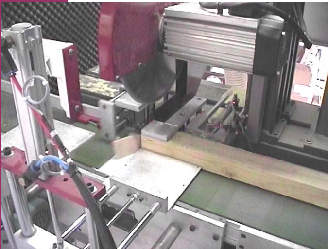
Tronçonnage de la coupe d'affranchissement. La chute est évacuée automatiquement sur le côté.
