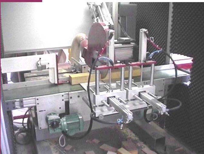
Vue de détail du poste de tronçonnage. A gauche la butée numérisée.
