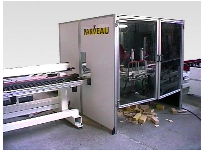
Vue du poste de tronçonnage. A gauche la table d'évacuation des bois avec la butée numérisée.
