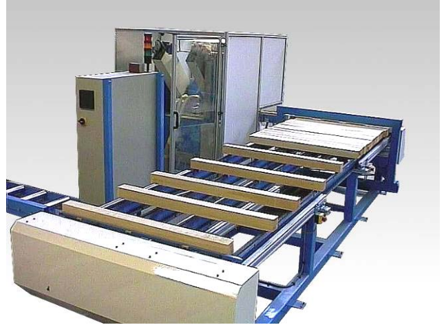
Vue latérale de la ligne avec en entrée la table à rouleaux motorisés, le transfert à 90° et son magasin chargeur horizontal avec accumulateur.
