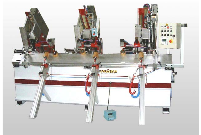
L'entraxe entre les unités de fichage est réglable manuellement
