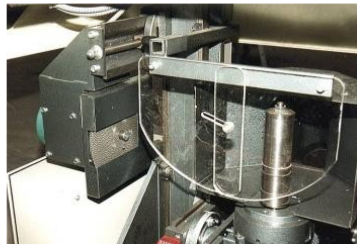
Vue de détail d'une épaveuse à l'arrière avec disque à plaquettes carbure (option)
