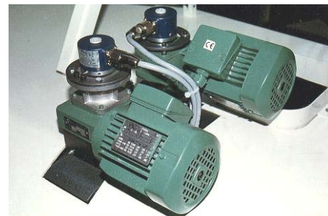
Motorisation par moteurs avec codeurs de mesure
