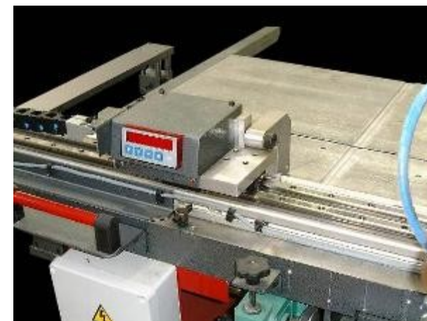
Exemple d'une table grande largeur avec rallonge et butée de règle. L'affichage digital de la cote est au 1/10e de millimètre
