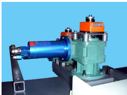
Motorisation par moteurs pneumatiques et compteurs Siko
