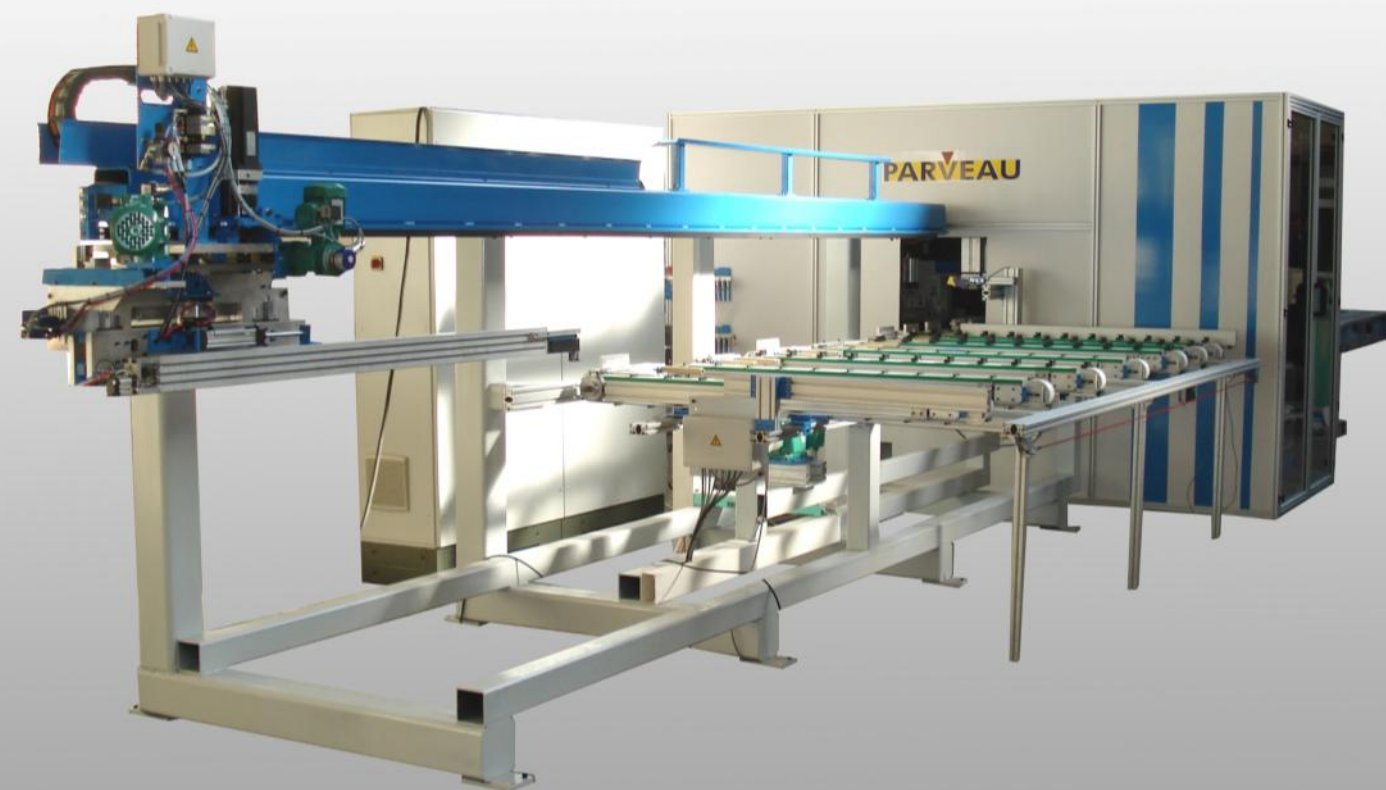
Centre d'usinage compact UN3 pour usinage de profils de menuiseries PVC
