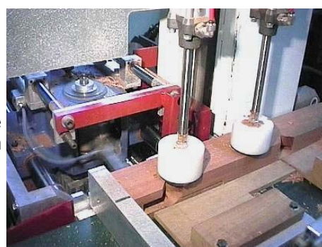
Unité de mortaisage monobédane en cours d'usinage
