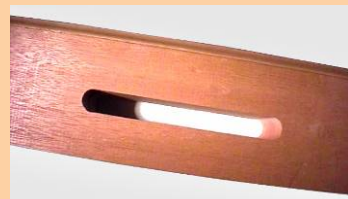
Défonçage des ventilations
