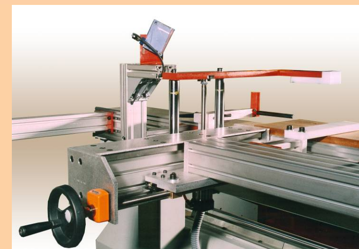
Détail de la table équipée d'une règle support butées d'appui permettant de positionner les pièces en contre référence. Il évite les butées côté usinage pouvant provoquer des collisions.
