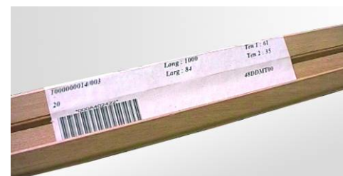
Étiquette avec codes barres permettant d'identifier une pièce (option)
