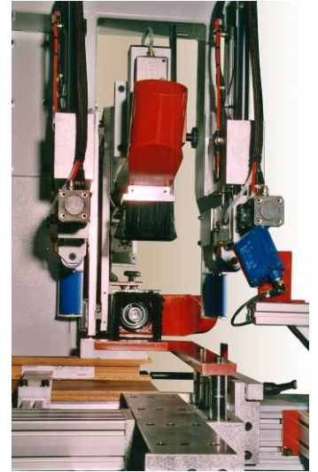
Unités de défonçage vertical et horizontal
