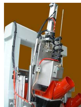
Unité de perçage incliné pour réalisation de drainages
