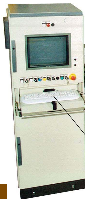
Pupitre de commande avec micro-ordinateur
