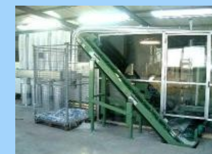
Système d'extraction et de relevage des chutes
